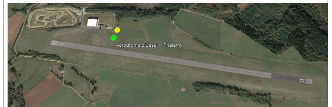
Cet emplacement est compatible avec le PSA. En effet, les mâts de manche à air les plus élevés en France culminent à 7,40 mètres. Sous une surface latérale de dégagement à 20%, cet équipement peut être implanté au plus près à 37 mètres de la limite de la bande de piste. Le nouvel emplacement envisagé respecte cette distance minimale.
